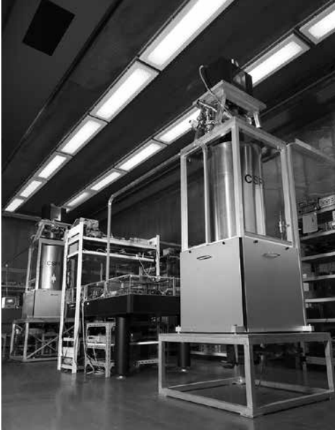
Abb. 2: Zwillingspärchen der Fontänenuhren CSF1 und CSF2 der Physikalisch-Technischen Bundesanstalt (PTB). In einem Laserstrahl bildet sich eine Wolke von Cäsiumatomen, die – wäre sie sichtbar – einer Wasserfontäne ähnelte. Foto: PTB.
